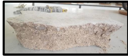
Rajah 4 : Sampel 'interlocking paver sand brick' selepas ujian mampatan
