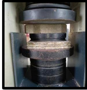
Rajah 3 : Ujian kekuatan mampatan sedang dijalankan ujian mampatan
