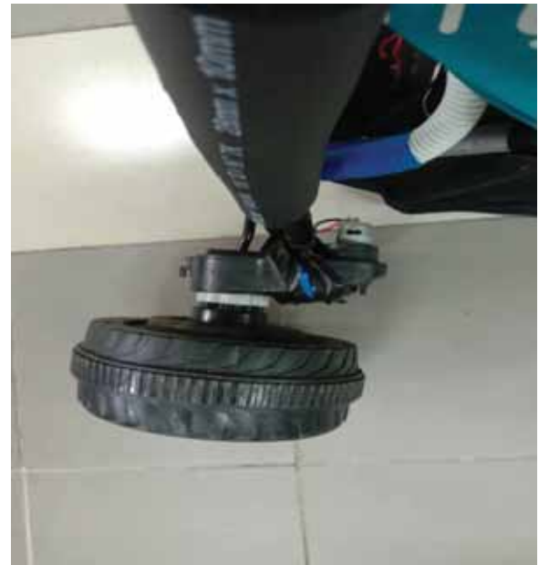
Gambarajah 5. Penggerak DC Motor diletakkan pada roda kereta sorong bayi
